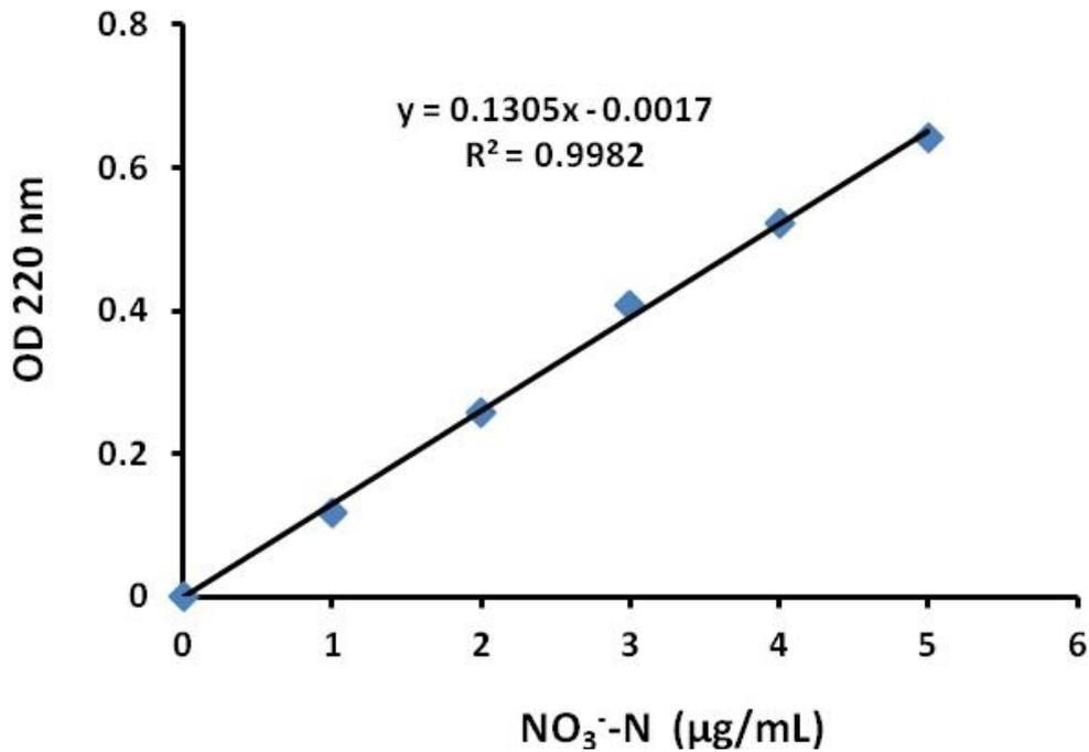
2、土壤硝态氮(NO<sub>3</sub><sup>-</sup>-N)含量(mg/kg 鲜土)=(△A+0.0017)÷0.1305×V÷W×D
